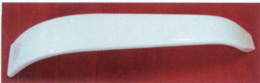
图10 修正喷漆后的起落架
