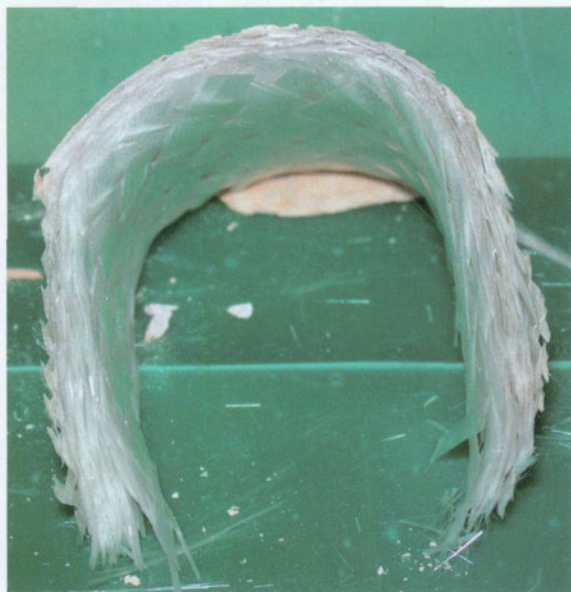
图2 进口起落架中间部分烧蚀后形貌
