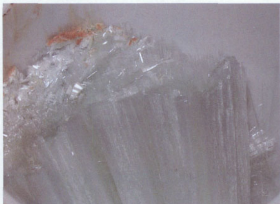
图1 进口起落架中部主受力部分烧蚀后形貌
